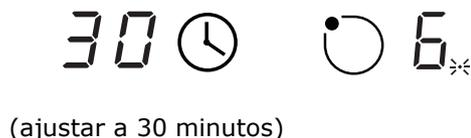
Pulse el mando de selección de zona de cocción, se mostrará el temporizador correspondiente en el indicador del temporizador.
